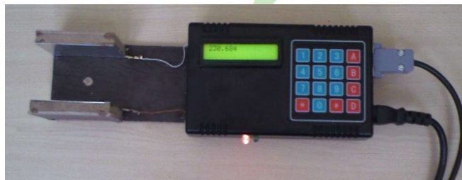
شکل ۳. دستگاه توزین تخم‌مرغ ساخته شده
