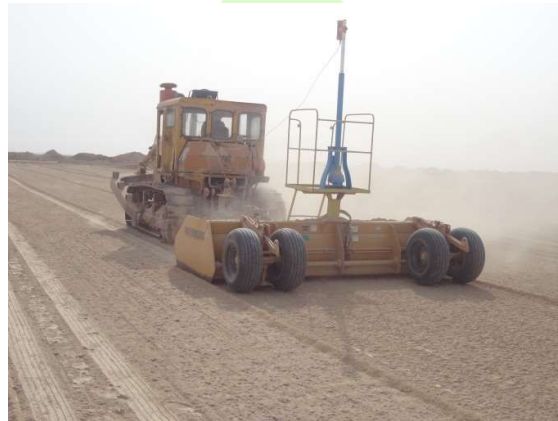
شکل ۲- دستگاه تسطیح لیزری کششی بولدوزری در حال عملیات تسطیح لیزری مزرعه
