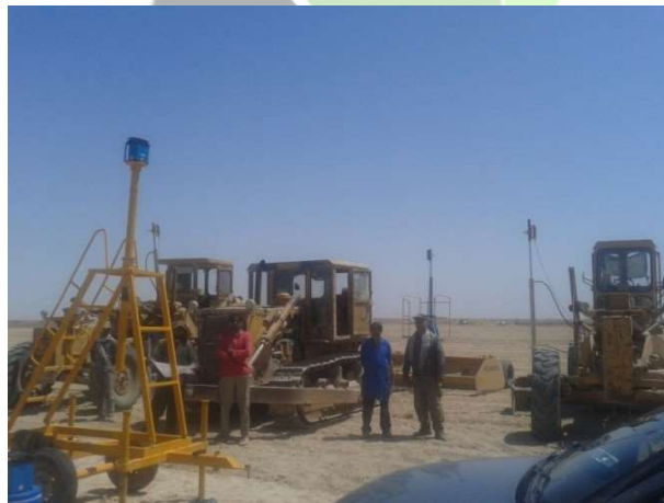
شکل ۳ - مجموعه ماشین آلات عمرانی با تجهیزات لیزری تسطیح اراضی
