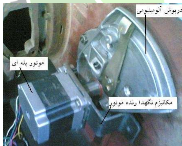
شکل ۵. موتور پله ای نصب شده بر روی تراکتور
