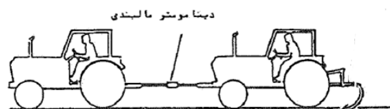
شکل (۱) اندازه‌گیری مقاومت کششی ادوات سوار شونده با استفاده از روش دو تراکتوری و دینامومتر مالبنده (لغوی و همکاران، ۱۳۷۶).
