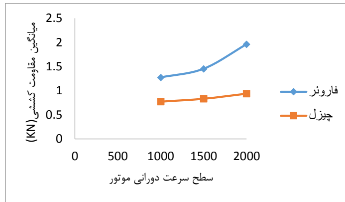
شکل ۳) تغییر میانگین مقاومت کششی ادوات در سرعت‌های دورانی مختلف موتور
