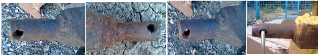
شکل ۱. میله‌های عرضی سالم و شکسته جوش شده.
