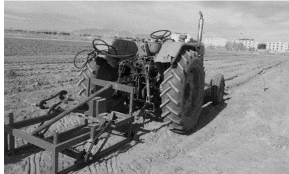
شکل ۱: دستگاه برداشت پیاز با محورهای زائده دار
