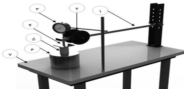
شکل ۳ - دستگاه برای انجام آزمون خزش؛ (۱) بازو، (۲) وزنه، (۳) جابجایی سنج، (۴) صفحه صلب بارگذاری، (۵) نمونه مورد آزمایش، (۶) صفحه صاف و صلب، (۷) شاسی (قاسمی و همکاران، ۱۳۹۳)
