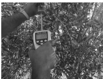
شکل ۶- بدست آوردن نیروی استاتیکی جداسازی میوه با استفاده از نیروسنج
