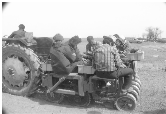
شکل ۱- ماشین نشاکار ۹ ردیفه در حین عملیات نشاکاری
