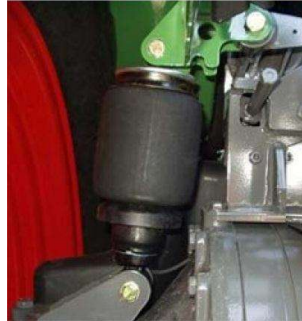
شکل ۸. میراگر ارتعاشی مجهز به فنر تقویت شده با هوا
