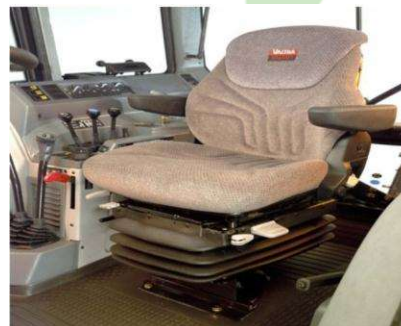
شکل 12. صندلی تراکتور والترا مجهز به سیستم تعلیق هوای پاسخ مثبت
