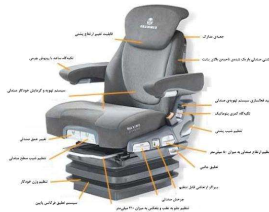
شکل ۲. صندلی تراکتور پیشرفته مجهز به سیستم تعلیق پنوماتیک
