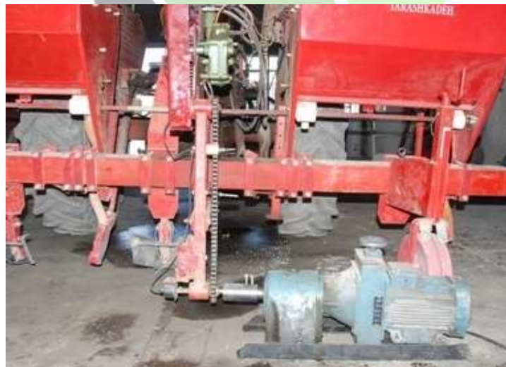
شکل ۵. شبیه سازی کارکرد دستگاه در مزرعه
