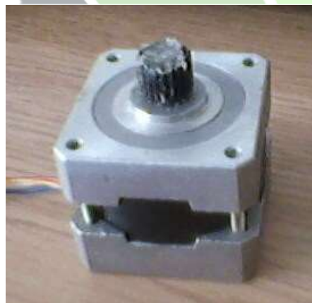
شکل ۷- موتور پله ای مورد استفاده در سیستم چرخش فرستنده‌ها
