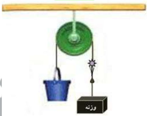
شکل ۲. مکانیزم تعیین مقاومت کششی و برشی
