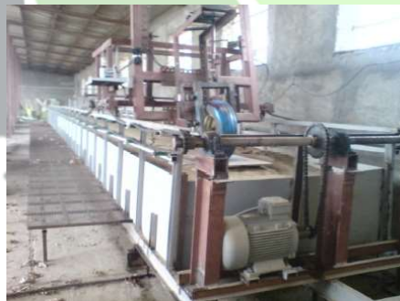
شکل ۱- آزمونگر تک چرخ و انباره خاک مورد استفاده در آزمون های تجربی
