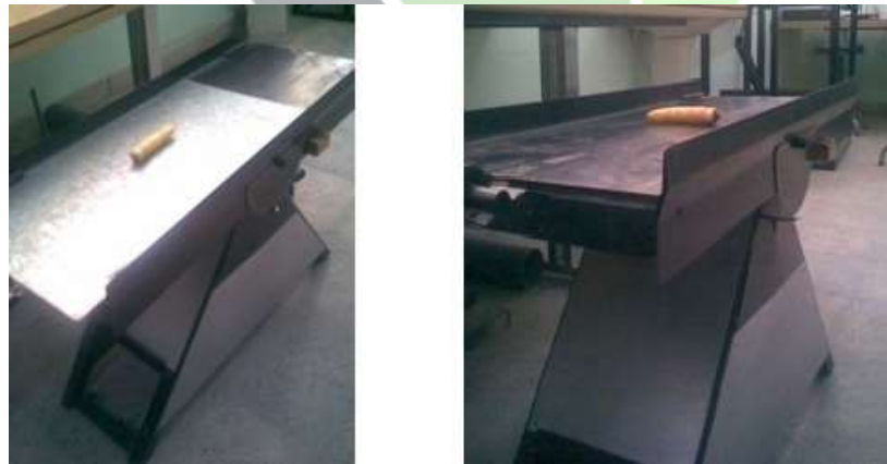
شکل ۱- آزمایش تعیین زاویه اصطکاک. چپ: لغزشی، راست: غلتشی
