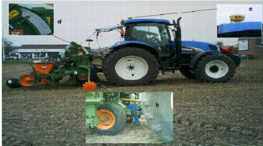
شکل ۲. سنسور VIS-NIR خاک مینی بر اعمال نرخ متغیر فسفر. (a) کارنده و کوددهنده. (b) واحد حسگر و نفوذسنج. (c) آنتن DGPS. (d) محرک الکتریکی. (e) غلتکی برای بستن تراشه ساخته شده توسط واحد نفوذ.
