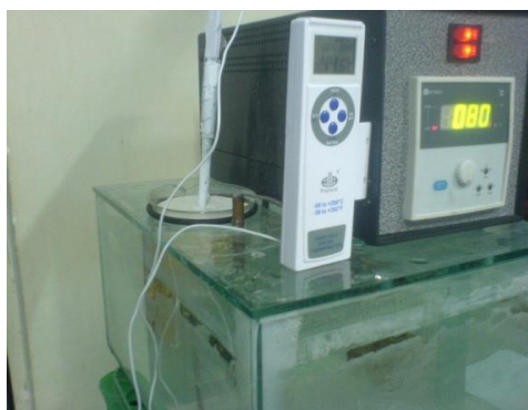
شکل 2: دستگاه اندازه‌گیری تغییرات دما ( \alpha t )
