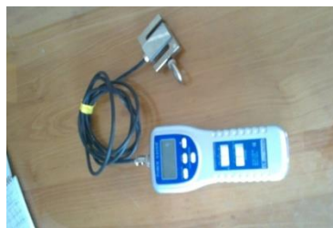
شکل ۱- دستگاه نیروسنج برای اندازه‌گیری نیروی کندن هر دانه ذرت
