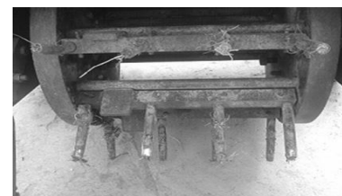
شکل ۱: ماشین هواده‌ی چمن روتوری با انگشتی استوانه‌ای و آرایش ردیفی
