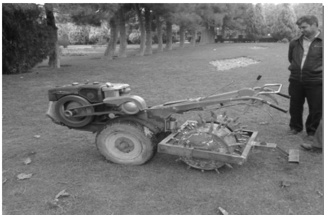
شکل ۶: دستگاه هواده ساخته شده متصل به تراکتور دو چرخ
