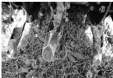
شکل ۳: ماشین هواده‌ی چمن روتوری با انگشتی‌های مخروطی و آرایش مارپیچی
