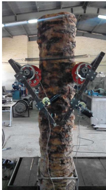
شکل ۲- ماشین با شاسی اتصال سریع ۷ شکل لولایی در حال بالا رفتن از تنه نخل خرما
