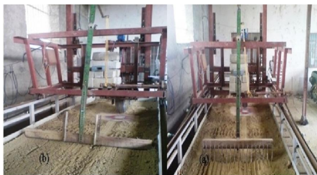
شکل ۵- (a) لولر نصب شده بر روی حامل (b) چنگه ساخته شده برای فرآوری خاک داخل کدال
