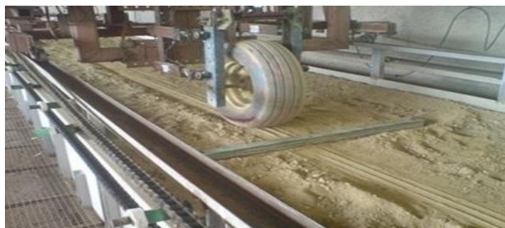
شکل ۷- حرکت چرخ روی مانع طی آزمایشات انجام شده در سویل بین
