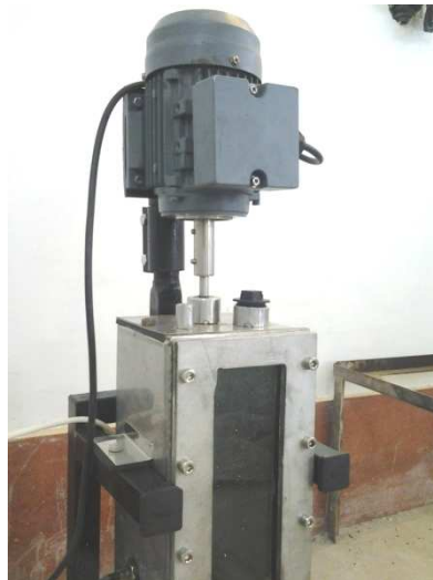
شکل ۵- نحوه قرارگیری الکتروموتور و راکتور بر روی شاسی
