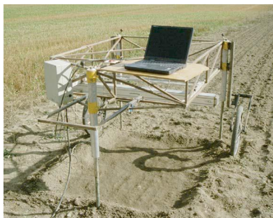
شکل ۳- تنظیمات لیزر برای اندازه‌گیری ارتفاع (Arvidsson & Bolenius, 2006).
