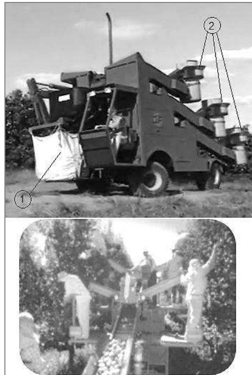
شکل ۴. سکو برداشت با واحدهای قابل تنظیم جدا از هم (۱) مخزن ذخیره سازی میوه برداشت شده، (۲) سکو
