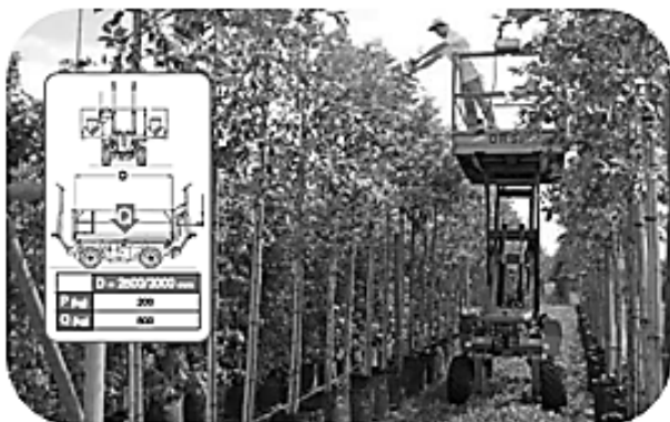
شکل ۲. سکوی برداشت با ارتفاع قابل تنظیم
