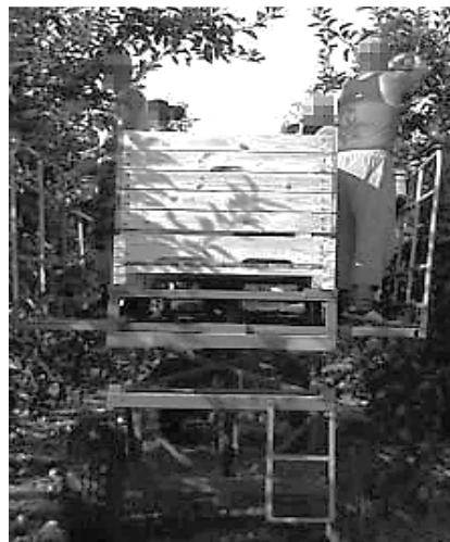
شکل ۱- سکوی چیدن میوه با ارتفاع ثابت
