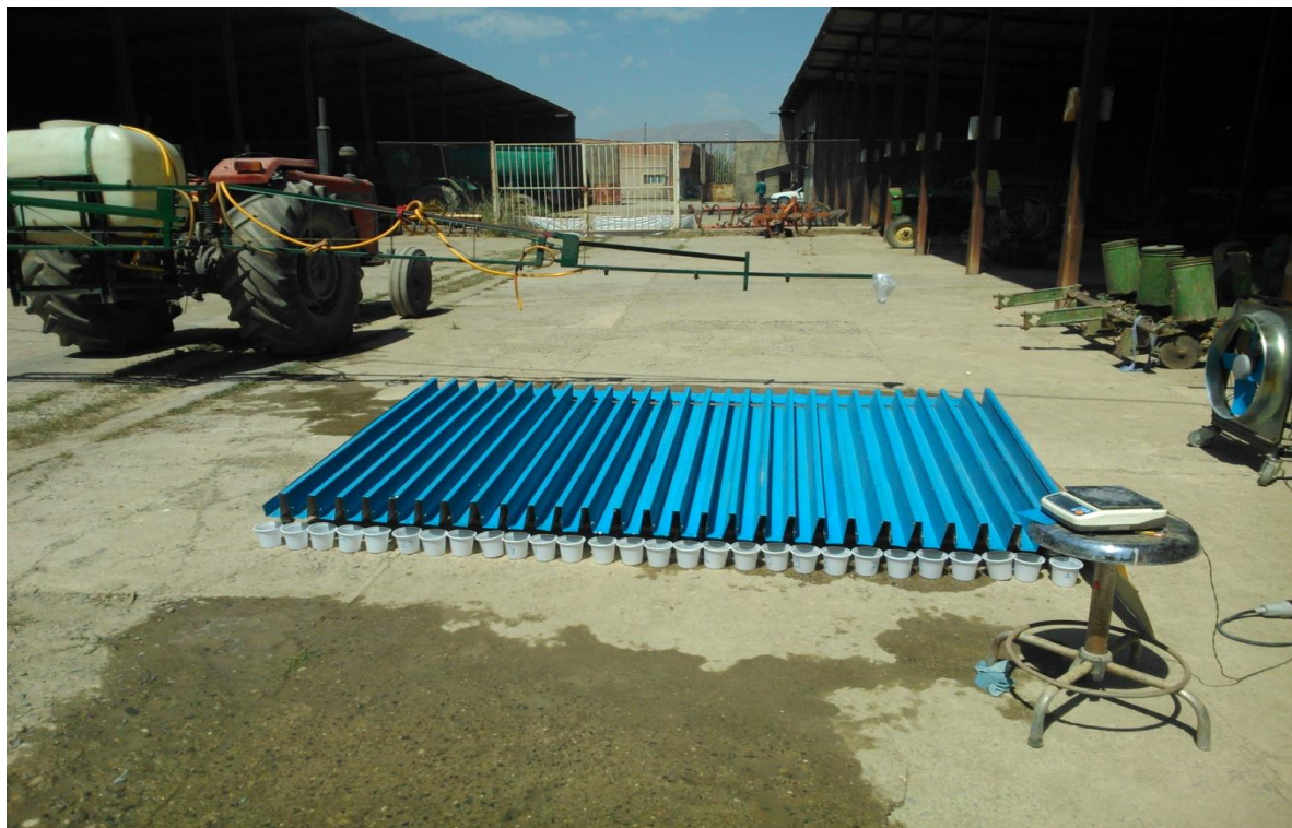
شکل ۱- اجرای آزمایش تاثیر باد بر توزیع سم، بر روی الگوسنج
