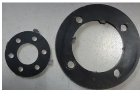
شکل ۱۸: گسیختگی صفحه برش ایمنی در دروگرهای بشقابی
