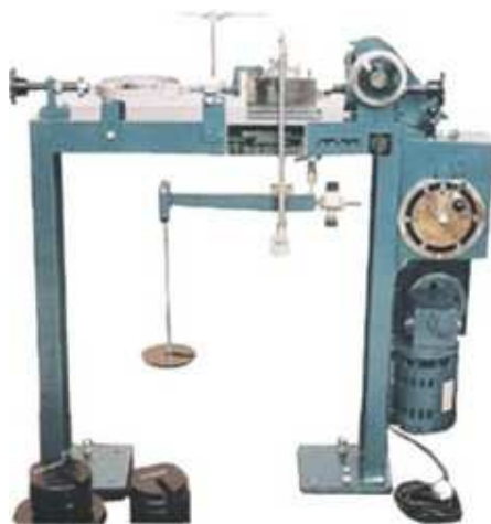
شکل ۱- نمونه‌ی قدیمی دستگاه کشش مستقیم خاک به همراه آویز بار عمودی و حسگر مکانیکی
