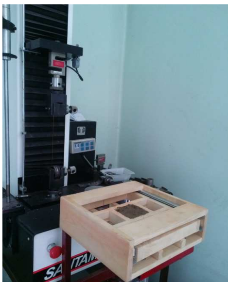
شکل ۵- جعبه‌ی برشی ساخته شده و نصب شده بر روی دستگاه کشش در حال آزمایش نمونه خاک
