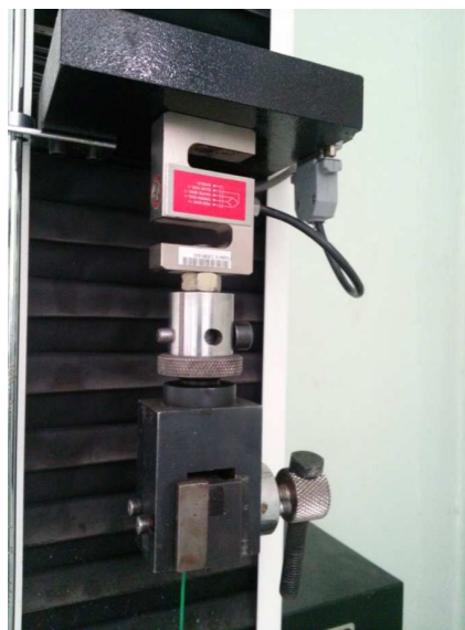
شکل ۳- نیروسنج کششی مورد استفاده در آزمایش
