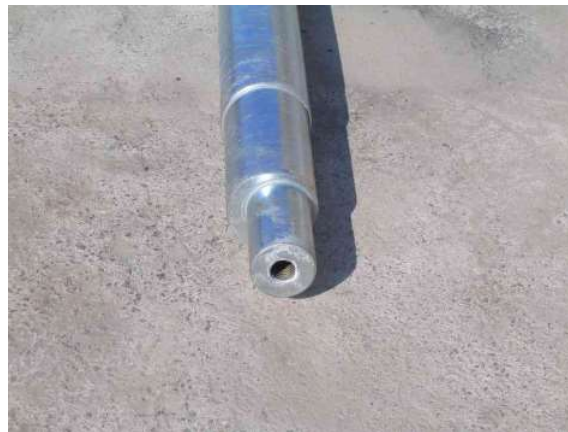
شکل ۳- شافت خارج از مرکز واحد لرزاننده
