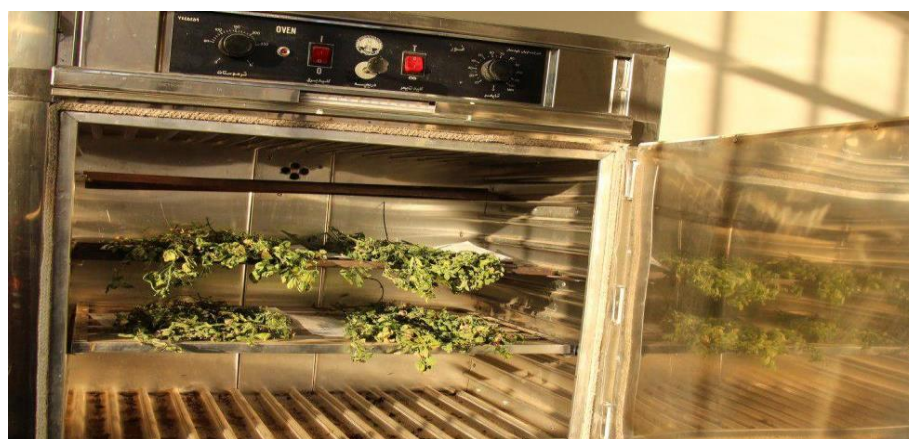
شکل ۲- قرار دادن محصول در داخل آون به منظور به دست آوردن مقدار ماده خشک
