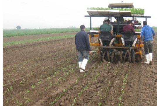
شکل ۱- ماشین نشاکار در حال کاشت نشاءهای کلزا
