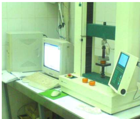
شکل ۳- دستگاه تست مواد در حین بارگذاری میوه خرمالو
