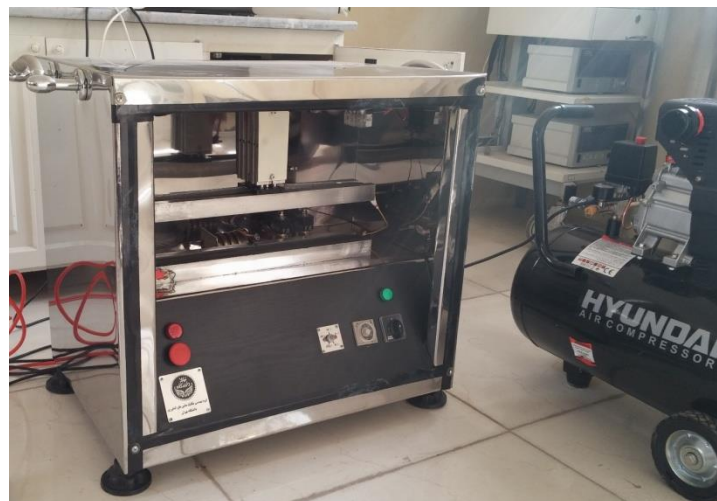
شکل ۴- دستگاه MAP طراحی شده برای انجام بسته‌بندی محصولات مختلف.
