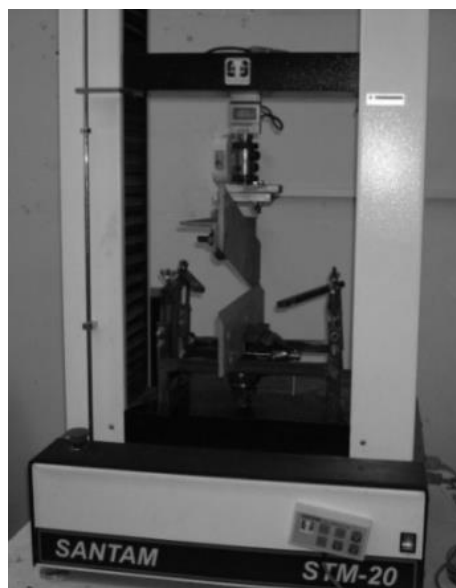
شکل ۱- تجهیزات ساخته شده برای نصب تیغه‌های ماشین بسته بندی روی دستگاه بارگذاری چند منظوره
