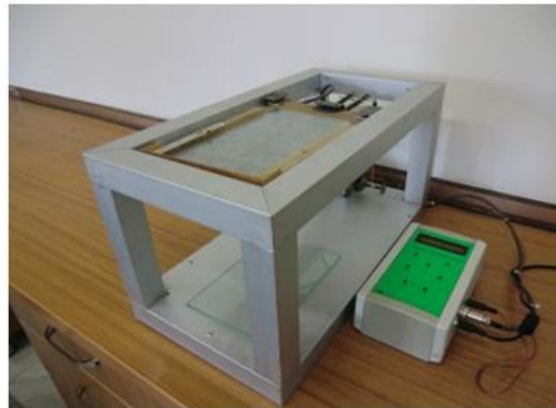
شکل ۳: دستگاه اندازه‌گیری ضریب اصطکاک ایستایی (Lorestani et al., 2013).
