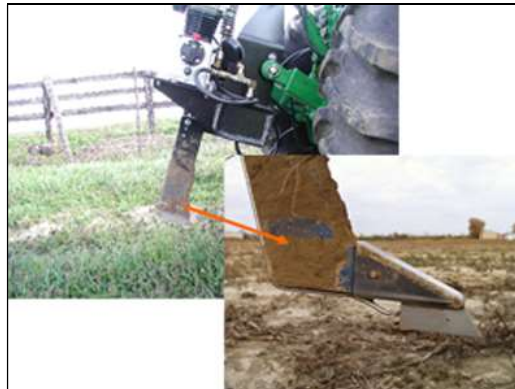
شکل ۶) استفاده از حسگر پنوماتیک برای تشخیص سخت لایه خاک
