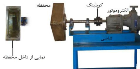
شکل 2 دستگاه آزمون دوام ساخته شده بر اساس استاندارد ASAE S269.4
