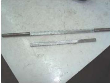
شکل-۱-ب. محور دریچه پس از تکمیل ماشینکاری
