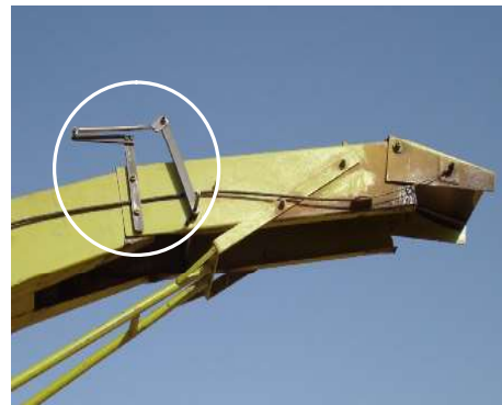
شکل-۳. تصویر فنر نصب شده برروی دریچه
