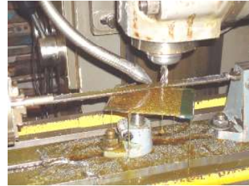
شکل-۱-الف. نحوه ماشینکاری محور دو قسمتی با دستگاه فرز
