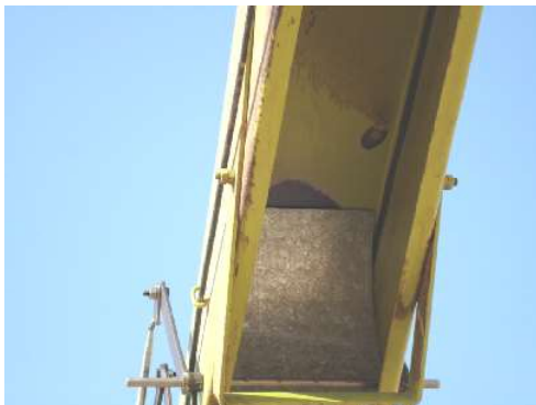
شکل-۲. تصویر دریچه نصب شده در دهانه خروجی چاپر
