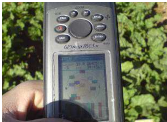
شکل ۵: GPS گارمین مدل map-76 با دقت ۳ متر.
