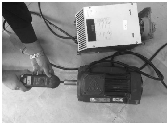
شکل ۳- کالیبره کردن دور الکترو موتور به وسیله دورسنج
