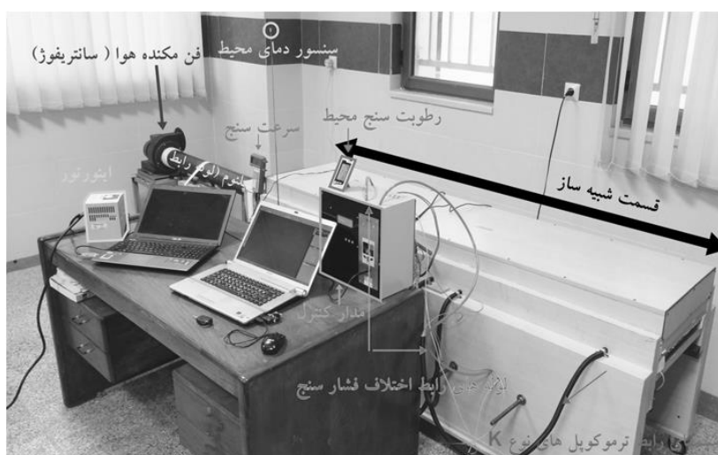
شکل ۳. شبیه‌ساز کالکتورهای صفحه تخت خورشیدی
