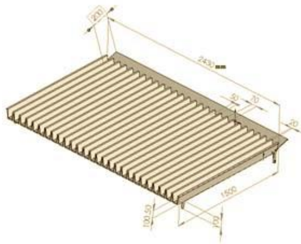
شکل ۱- شماتیک هندسی الگوسنج سمپاشی
