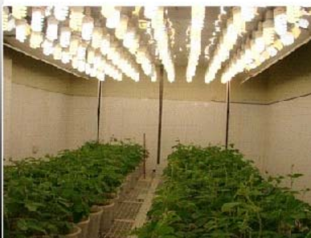
شکل ۳. سامانه تابشی با ارتفاع قابل تنظیم میز کشت تحقیقاتی.
