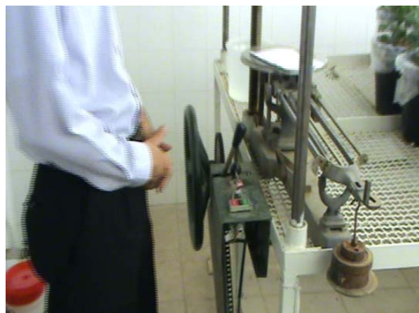
شکل ۲. نمایی از فلکه تنظیم ارتفاع سقف تابشی
