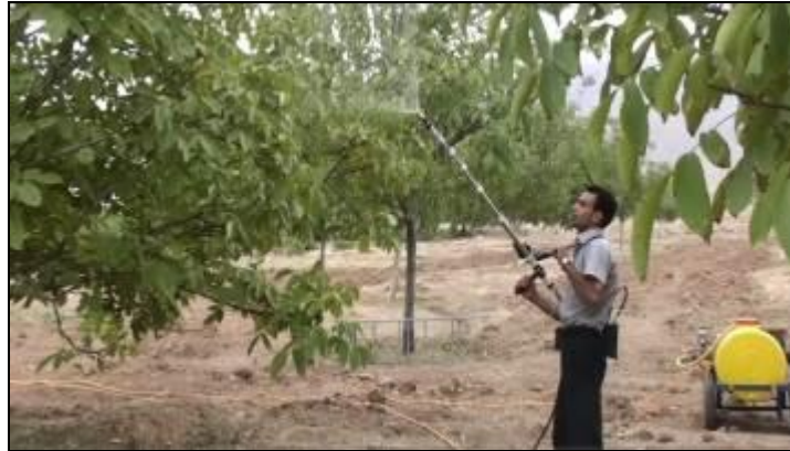
شکل ۱. سمپاش فرقونی مجهز به بوم تلسکوپی در حال سمپاشی (جعفری ملک‌آبادی و همکاران، ۱۳۹۳).
