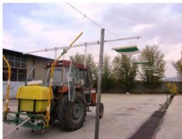
شکل ۲. سمپاش باغی مبتنی بر بینایی ماشین (آسائی و همکاران، ۱۳۹۲)
