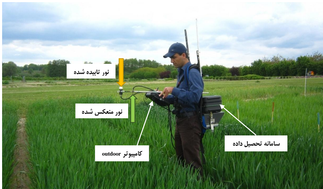
شکل ۱- اسپکترورادیومتر مورد استفاده برای اندازه‌گیری بازتاب طیفی گیاه و خاک
