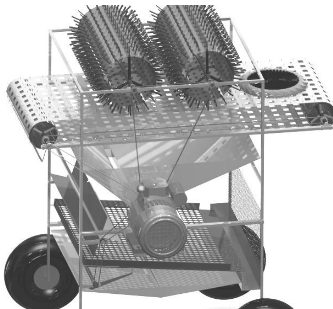
شکل ۵. دستگاه بوجاری و بسته بندی گل آفتابگردان.
