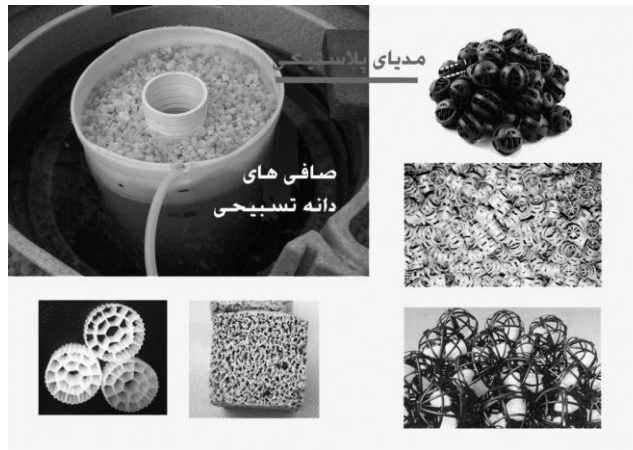
شکل ۶. صافی‌های دانه شناور به همراه دانه‌های پلی اتیلن (Anonymous, 2013)
