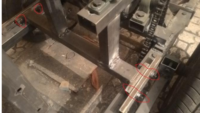
شکل (۱۳) محل جابجایی چرخ زنجیرهای عقب
