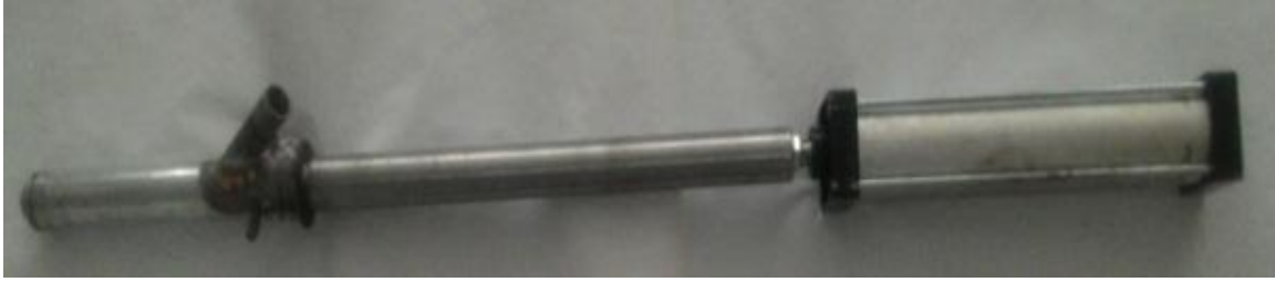
شکل (۸) جک پنوماتیکی و میله فرورونده
