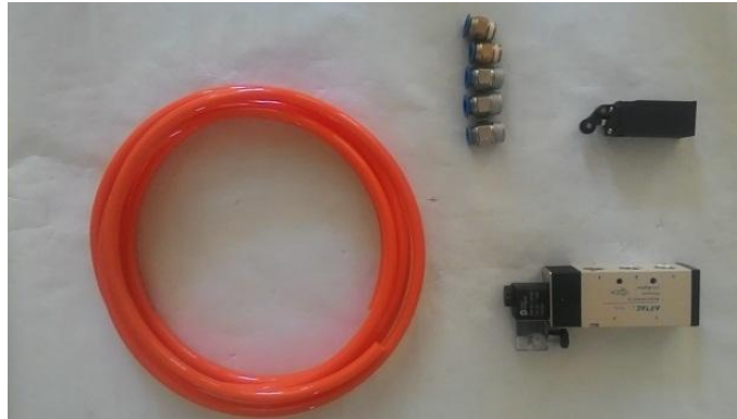
شکل (۱۴) شلنگ، شیر الکتریکی، میکروسویچ
