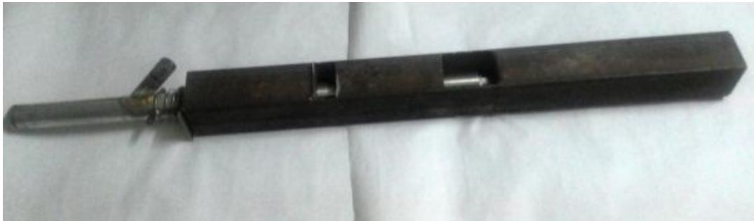
شکل (۹) پوسته که جک پنوماتیکی و میله را در خود جا داده
