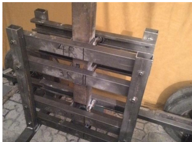
شکل (۱۱) ریل‌هایی برای سوار شدن حفره‌ساز
