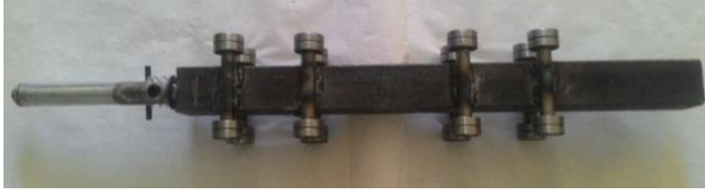
شکل (۱۰) بلبرینگ‌هایی که روی پوسته نصب شده
