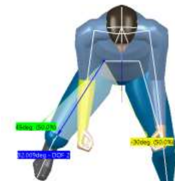
شکل ۹. زاویه قرارگیری ران پای راست در موقعیت کنترل پدال گاز.
