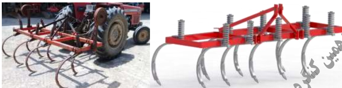
Figure 1. Figure and Solid 3D model chisel plow. شکل ۱ - شکل و مدل جامد 3D گاوآهن قلمی.
