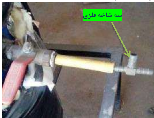
شکل ۵- سه شاخه فلزی برای خروج گاز و نصب فشار سنج
